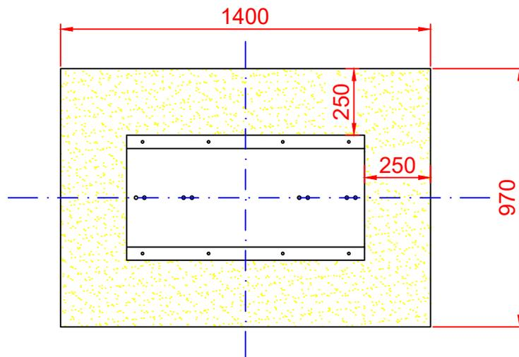
ESQUEMA DE CIMENTACIÓN EN HORMIGÓN
