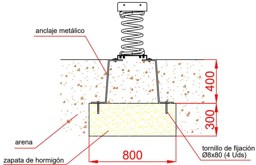
ESQUEMA DE CIMENTACIÓN EN HORMIGÓN
