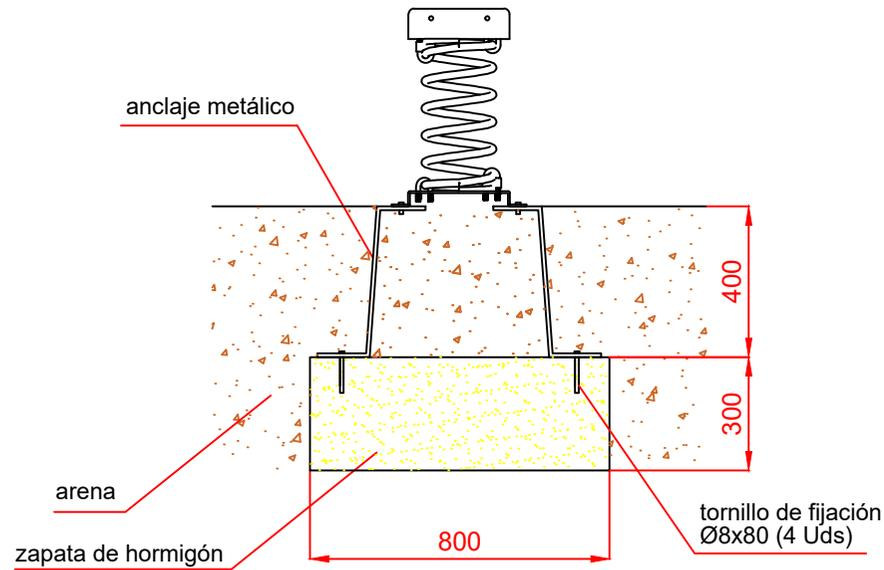
ESQUEMA DE CIMENTACIÓN EN HORMIGÓN
