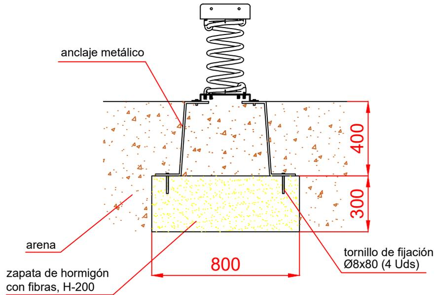
ESQUEMA DE CIMENTACIÓN EN HORMIGÓN
