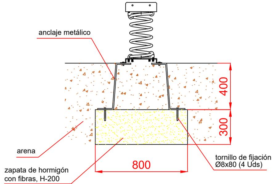
ESQUEMA DE CIMENTACIÓN EN HORMIGÓN
