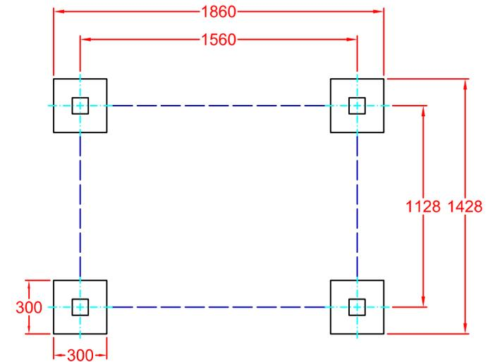
ESQUEMA DE CIMENTACIÓN PARA CASOS EN LOS QUE VA ATORNILLADO SOBRE SOLERA DE HORMIGÓN
