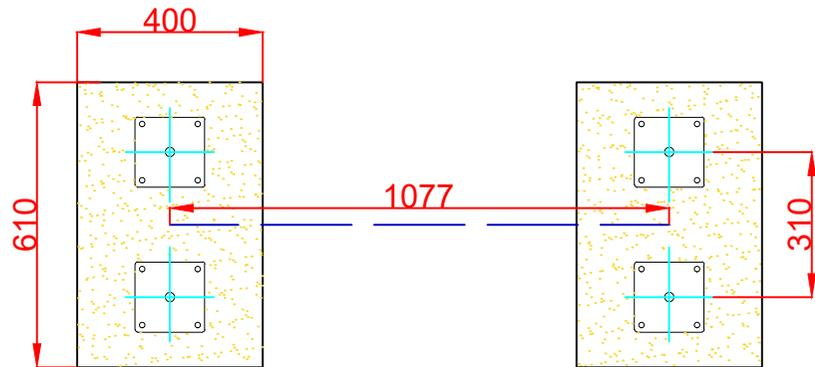
ESQUEMA DE CIMENTACIÓN EN HORMIGÓN
