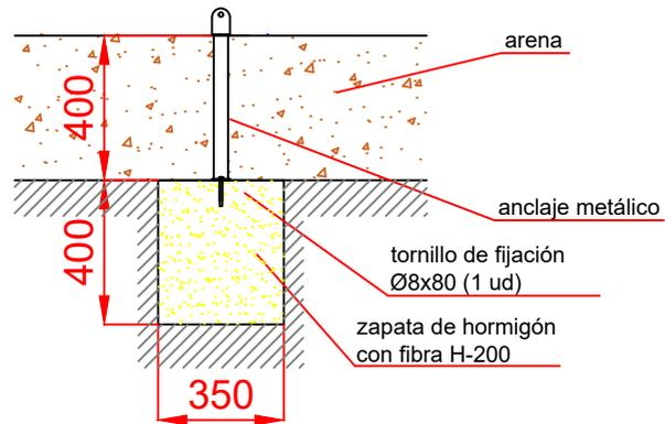
ESQUEMA DE CIMENTACIÓN EN HORMIGÓN
