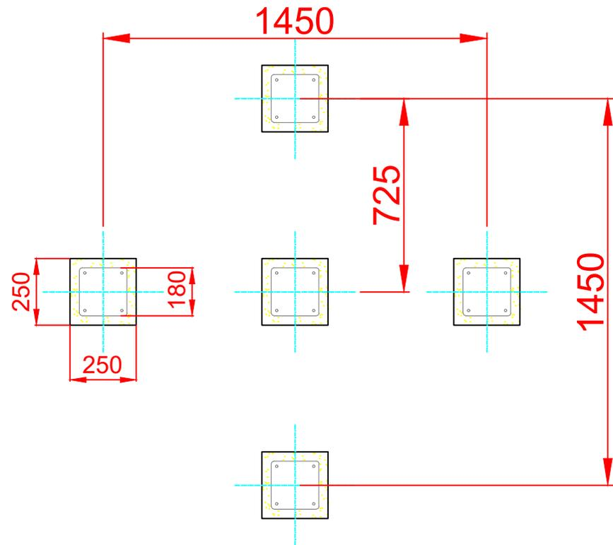
ESQUEMA DE CIMENTACIÓN EN HORMIGÓN
