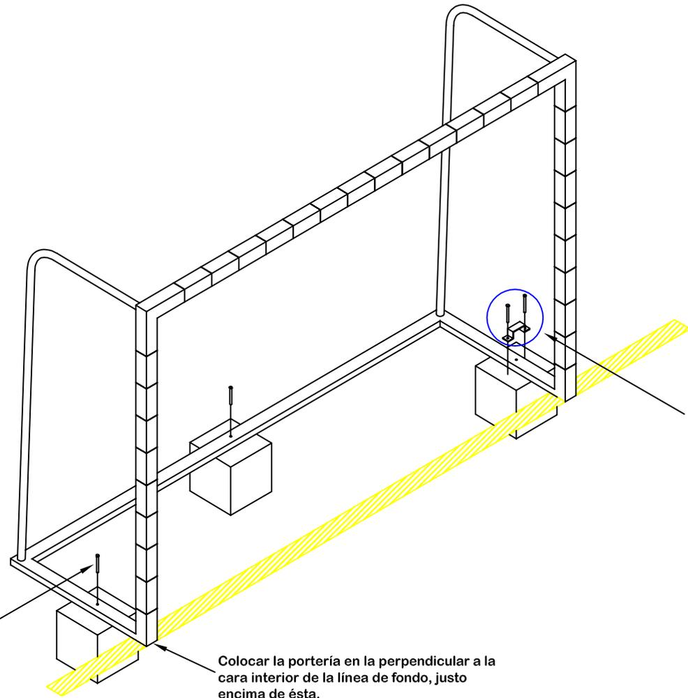
**1ª Posibilidad de Montaje (portería fija):** atornillar directamente la portería al dado de hormigón. Aconsejable utilizar taco de plástico 10x80 y tornillo de cabeza hexagonal de 10x100.
